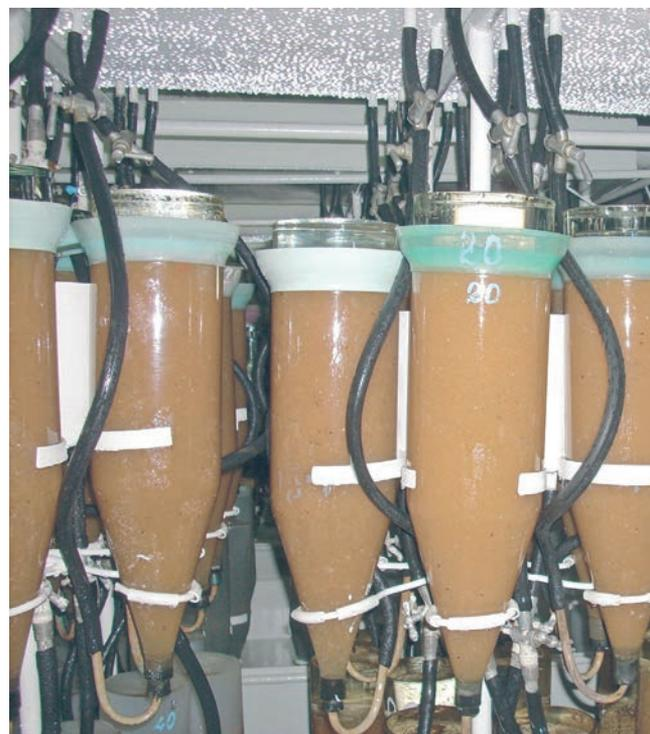
этой проблемы работа пошла в гору. Сначала икра инкубировалась в русле реки, в аппаратах Сизгина, позже перешли на аппараты Вийса, которые служат заводу по сей день.
