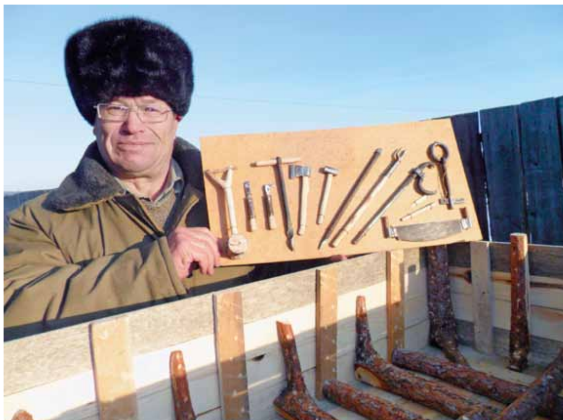
Название инструментов и приспособлений для изготовления карбаза. Слево направо: 1. колотушка; 2. конопатка — простая; 3. конопатка — «косач»; 4. напария; 5. топор; 6. кувалда; 7. лом; 8. «черта» — циркуль; 9. захват; 10. жим-тяж; 11. пила; 12. шкант; 13. клин — «пятничка».
